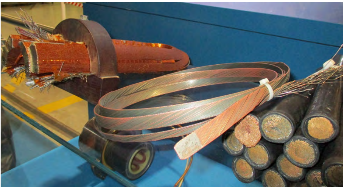
Fig. 4 - Fili di materiale superconduttore in matrici metalliche di forma diversa (CERN CRYOGENICS)
